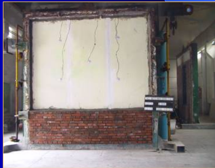
左上图：垂直构件耐火 试验炉
