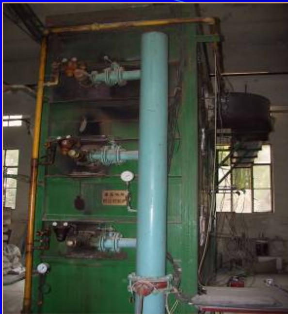
左上图：垂直构件耐火 试验炉
