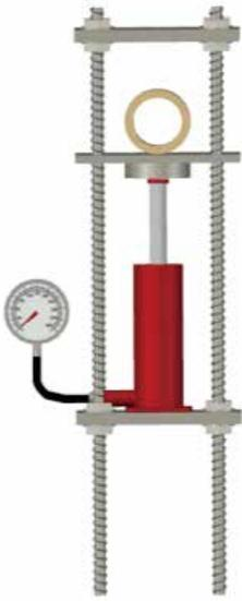
**Figure 6: Edge Bearing Test**
