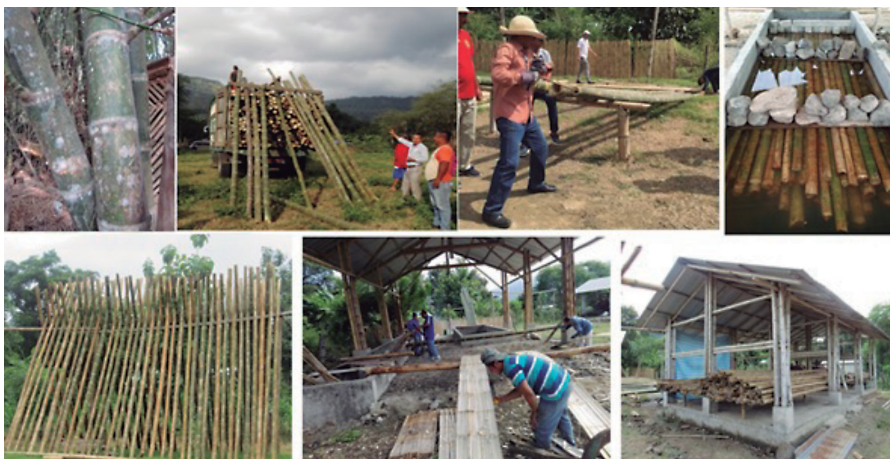
Figura 14. Proceso de transporte, preservado, secado y almacenamiento de bambú, Ecuador
