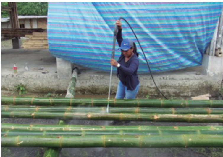
Figura 13. Limpieza de bambú con hidrolavadora, Ecuador
